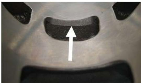
La flangia di chiusura della cavità di scarico può mostrare superfici finite di metallo pressofuso o segni di lavorazione da parte del costruttore.
