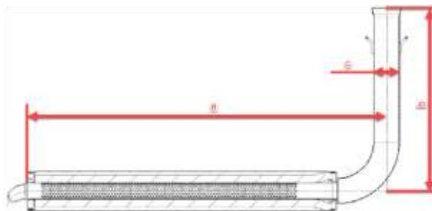
Un sfera d'acciaio del diametro di 28,0 mm **non deve** poter passare nella sezione "A" e una sfera d'acciaio del diametro di 26,0 mm **deve** poter passare nella sezione "A" all'interno della curva 90 gradi della marmitta (i componenti interna devono essere smontato per misurare)
