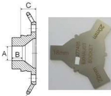
Il profilo all'interno dell'collettore di scarico deve essere misurato con la dima Rotax 277 405.
