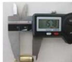
Lunghezza parte cilindrica atomizzatore 15,75 +/- 0,25 mm
