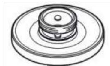
I due raccordi di sfiato devono essere collegati con l'originale tubo di sfiato, minimo 155mm (codice Rotax 260260). La posizione di apertura del tubo deve esser posizionata sul lato posteriore del carburatore.
