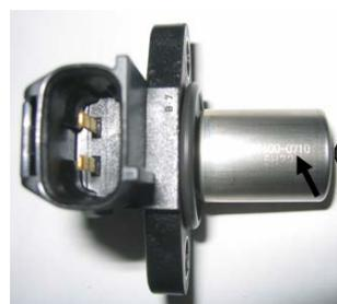
È possibile montare massimo due guarnizione (Rotax 431 500, spessore 0,8mm) tra il pick-up e il basamento (piano pick-up non lavorato)
