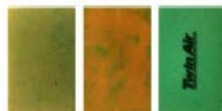
Dipende del grado della lubrificazione del filtro e da come stato pulito, il color può variare.
