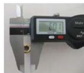
Diametro del foro perpendicolare nell'atomizzatore 5,0 +/- 0,15 mm
