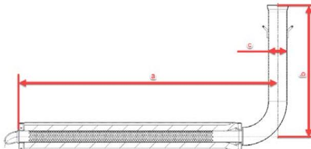
Un sfera d'acciaio del diametro di 28,0 mm **non deve** poter passare nella sezione "A" e una sfera d'acciaio del diametro di 26,0 mm **deve** poter passare nella sezione "A" all'interno della curva 90 gradi della marmitta (i componenti interna devono essere smontato per misurare)
