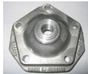
Il profilo dell'inserto deve essere controllato con una dima ROTAX parte n. 277 390) con una luce uniforme fra la dima e la testata lungo tutto il profilo.
