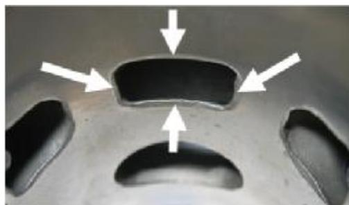
Sui cilindri riportanti il codice 223 993 e 223 994 la lavorazione CNC del bordo superiore della luce di alimentazione centrale è permessa.
