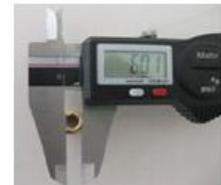
Diametro del foro perpendicolare nell'atomizzatore 5,0 +/- 0,15 mm
