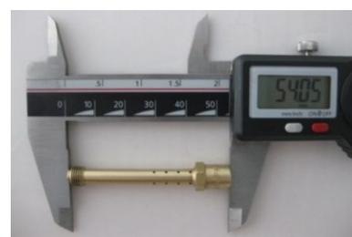
Diametro foro superiore 2,60 +/- 0,15mm
