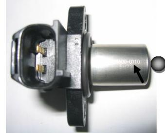
È possibile montare massimo due guarnizione (Rotax 431 500, spessore 0,8mm) tra il pick-up e il basamento (piano pick-up non lavorato)
