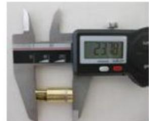
Lunghezza parte cilindrica atomizzatore 15,75 +/- 0,25 mm
